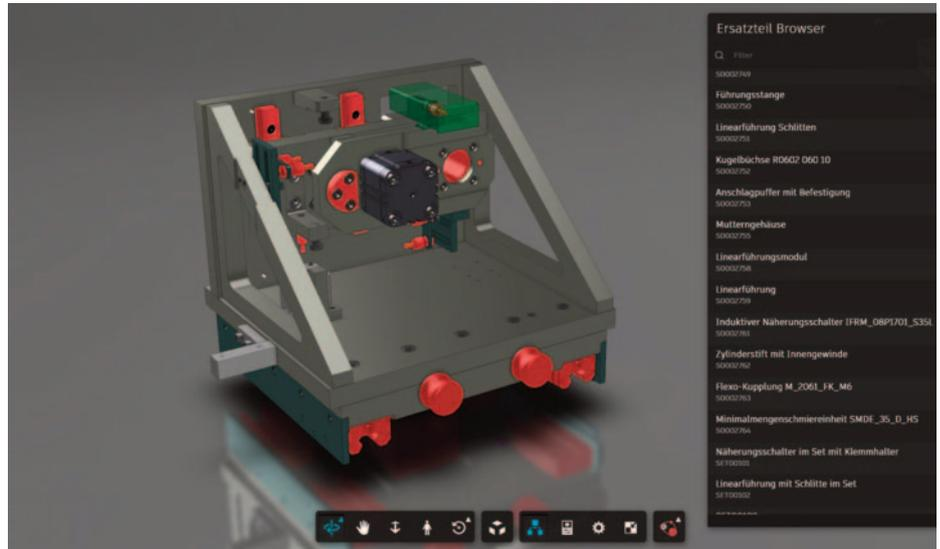
Aus den CAD-Daten entsteht dann eine 3D-Viewer-Ansicht des Produktes, in der ein Endkunde direkt die Ersatzteile auswählen kann, die er benötigt.“
