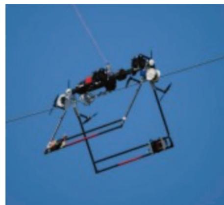
Der "Mini LineFly"-Roboter rettet im Verbund mit einer Drohne Vögel, indem er an Freileitungen, die für die Tiere schlecht sichtbar sind, Markierungen anbringt. Das verhindert Kollisionen, denen unzählige Vögel zum Opfer fallen. Das Vogelschutzsystem hat Fulcrum Air entwickelt. Nach den Erfahrungen des Übertragungsnetzbetreibers TenneT ([www.tennet.eu/de](http://www.tennet.eu/de)) in der niederländischen Stadt Arnheim sinkt die Zahl der Kollisionen durch Leitungsmarkierungen um 70 Prozent.
